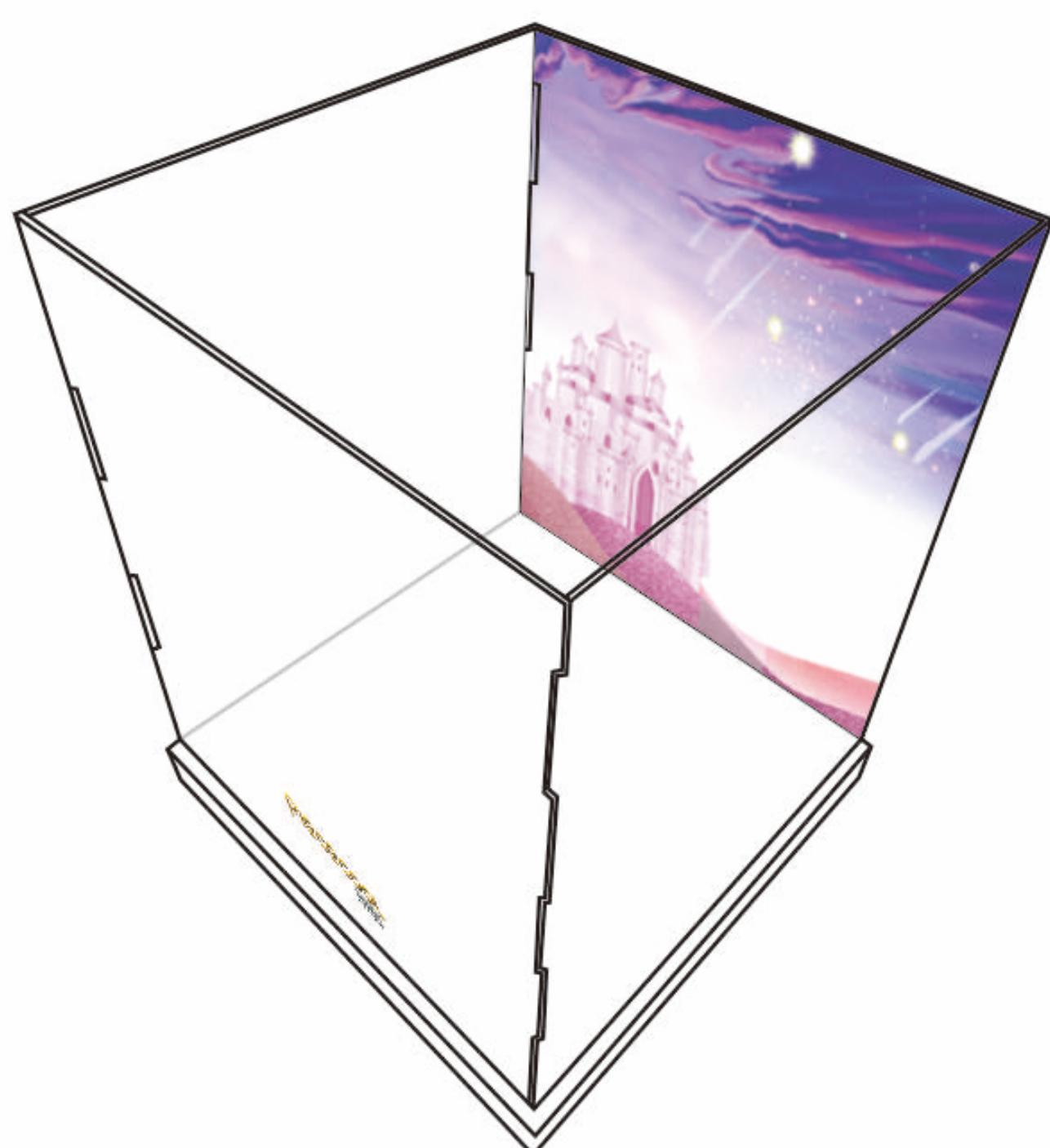
按照图例，将四块侧板凹凸对应拼插入底板；
